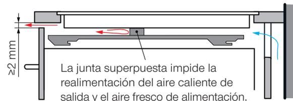
Las chapas protectoras de ventilación solo ofrecen el efecto deseado con la junta superpuesta. Por tanto también se pueden adquirir juntas de espuma para equipar chapas de otros productos.
